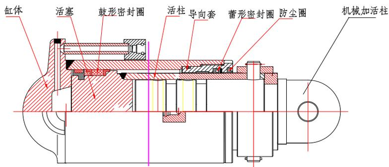
立柱主要有活柱组件、缸体部件、缸口导向组件和机械加长组件、底阀和其它连接部件组成。
